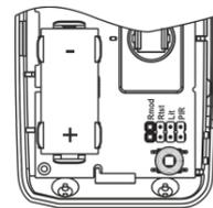
При установке ЭП в извещатель автоматически производится «активация» и проверка ЭП в течение времени выхода в дежурный режим. При этом индикатор включен красным цветом (не более 20 с). После выполнения проверки (в течение времени не более 60 с), если извещатель не выдал извещение «Неисправность питания», ЭП считается пригодным.
