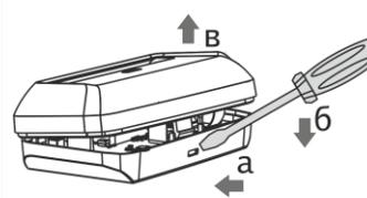
**2** Отогнуть зацеп на основании. Снять плату
